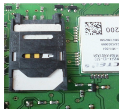
Закреть лоток. Задвинуть крышку по направлению стрелки.
