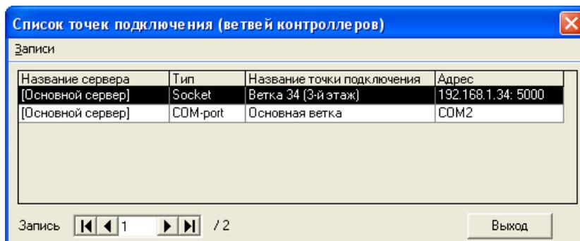
Для каждого преобразователя Gate-Ethernet (также, как и для каждого COM-порта) должна быть создана отдельная точка подключения.
