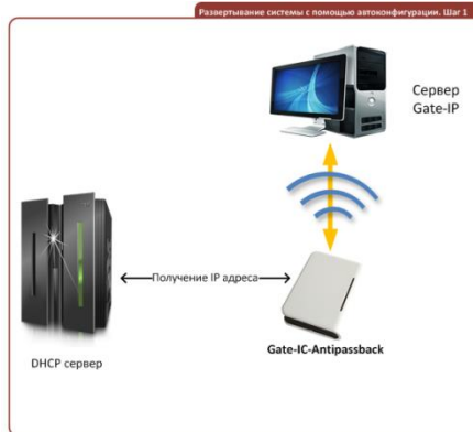
Рис 6. Подключение контроллера Gate-IC-Antipassback
