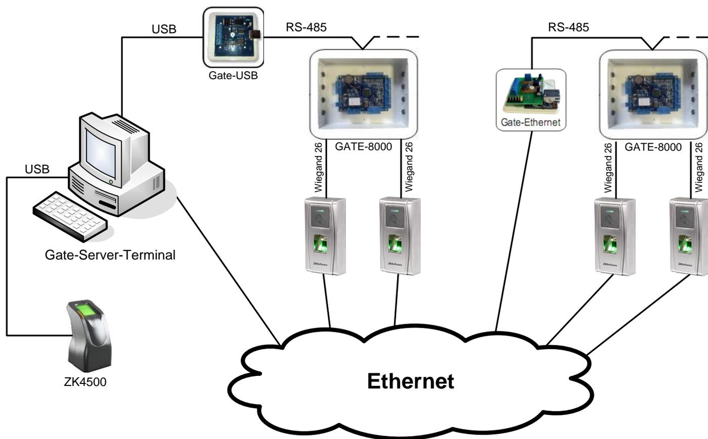
Каждый считыватель ZK должен быть подключен по интерфейсу Wiegand -26 к контроллеру GATE для работы в качестве считывателя и по сети Ethernet для настройки и программирования из ПО (данные операции выполняются из программы Gate-Terminal).
