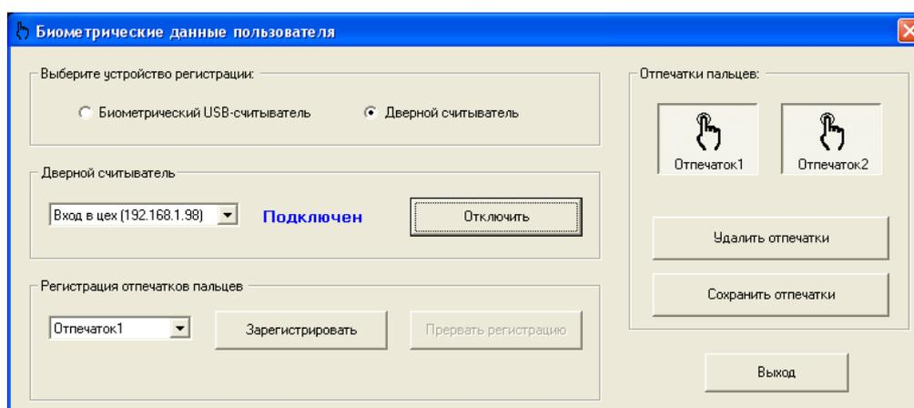
Б.2 Если выбранный считыватель находится в состоянии «Отключен», то нажмите кнопку «**Подключить**». В случае успешного подключения станет доступна группа операция «Регистрация отпечатков пальцев»
