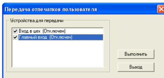
Снимите отметку с тех считывателей, в которые не нужно выполнять передачу (например, по причине их недоступности в данный момент) и нажмите «**Выполнить**».
