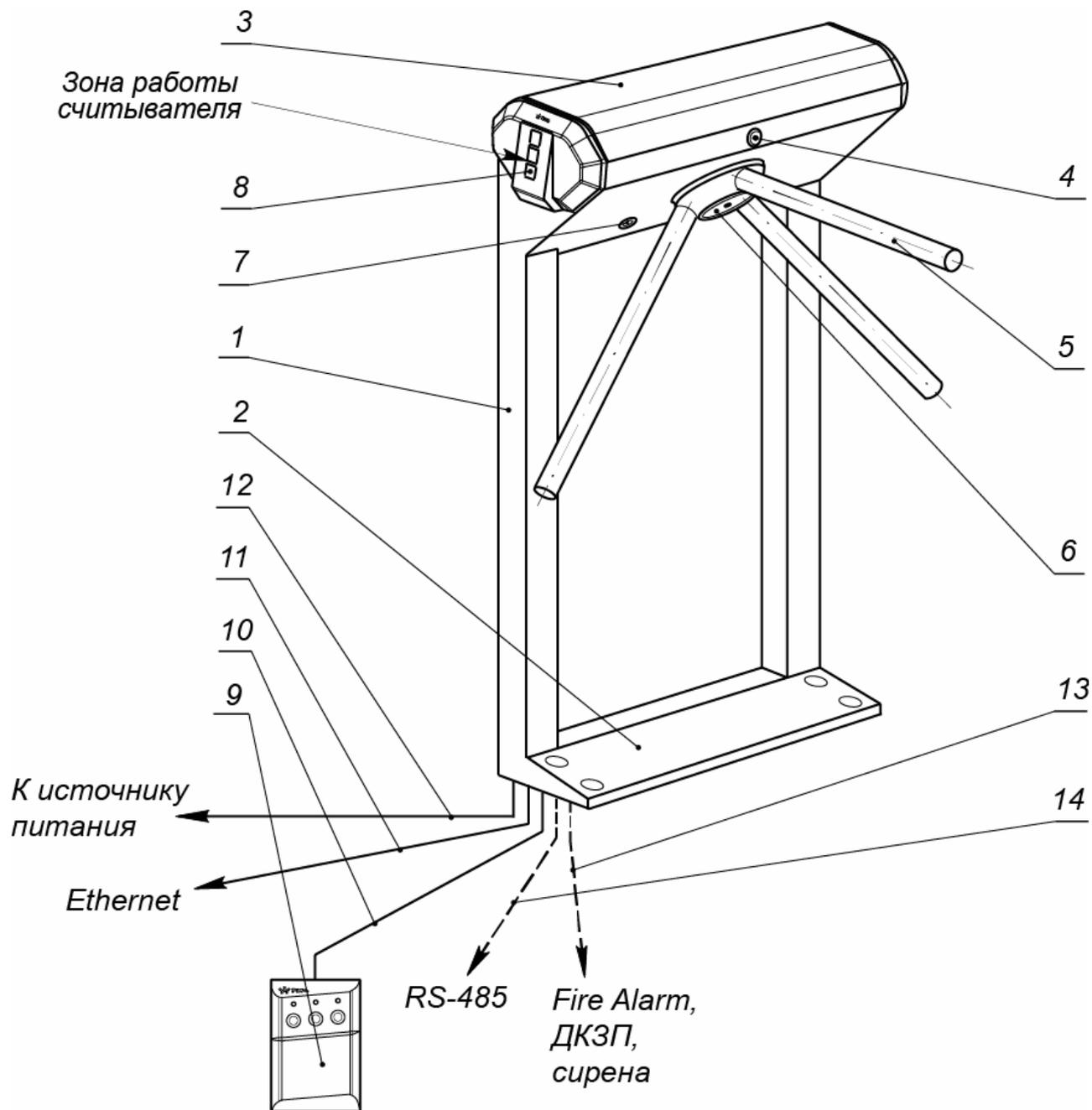
**Рисунок 1. Устройство ЭП**
