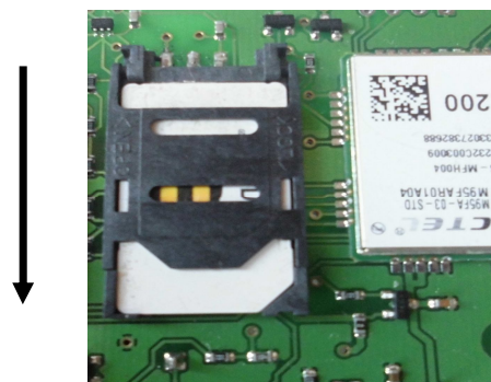
Закреть лоток. Задвинуть крышку по направлению стрелки.
