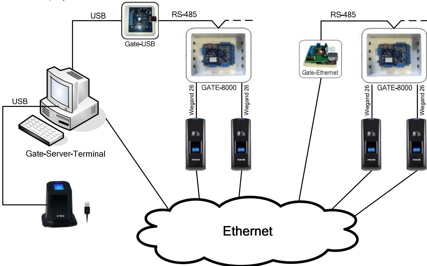
Каждый считыватель Anviz должен быть подключен по интерфейсу Wiegand -26 к контроллеру GATE для работы в качестве считывателя и по сети Ethernet для настройки и программирования из ПО (данные операции выполняются из программы Gate-Terminal). Настольный USB-считыватель (U-Bio) подключается к компьютеру, с которого производится регистрация.
